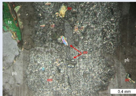
Hình 3: Granodiorite. Plagioclase I (pl) song tinh đa hợp bị sericite (src) hóa và zoisite-epidote (zo) hóa. Lm QT02; 2Ni + .
